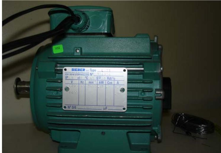
Fig. C-1 Fotografía del motor de inducción utilizado
